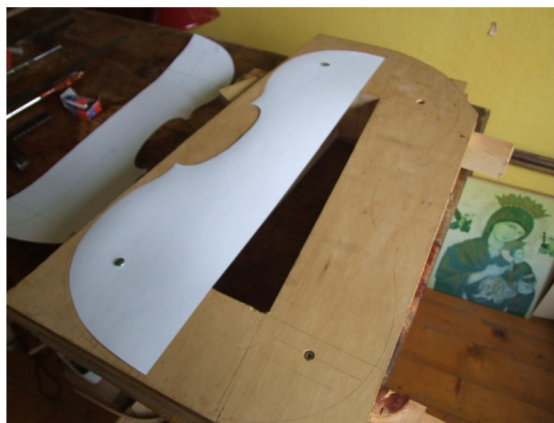
Przenoszenie konturu na sklejone deski.
